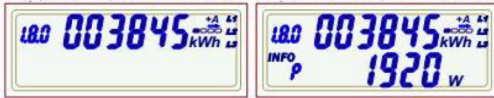
Abb. 7: Anzeige Bezugszähler ohne (links) und mit (rechts) Leistungsanzeige
